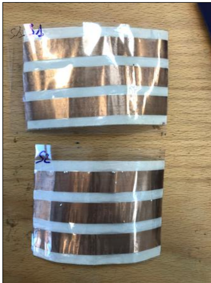
Figura 7: provini S1 e S2 per prova d'urto ricavati da campione costituito da un nastro conduttivo NIR con tre piste protetto da pellicola.
