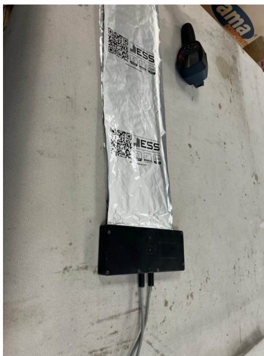
Figura 48: La corrente circola nel tessuto trasformandosi in energia termica che si traduce in un rilascio di calore.
