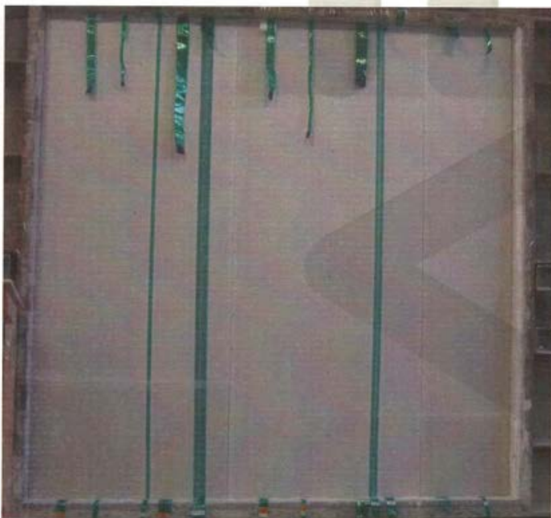
Foto 4: Strato esterno del lato non esposto al fuoco prima dell'applicazione dello stucco a base di gesso
