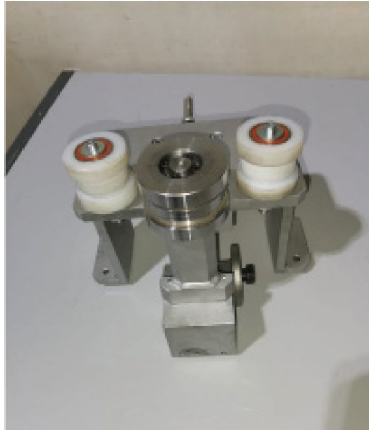
Figura 29: La Calandra è lo strumento appositamente studiato per curvare i profili e personalizzare le lampade rendendo ogni progetto unico.
