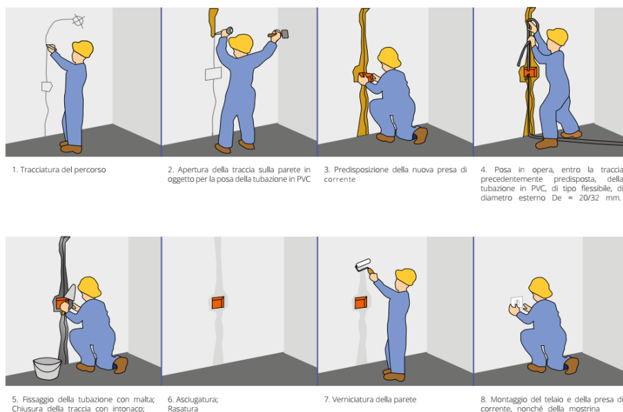
Figura 13: Realizzazione linea tradizionale
