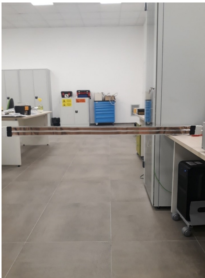
Figura 3: setup del test per la valutazione della portata elettrica di un nastro elettrico piatto Next-Tape in aria.
