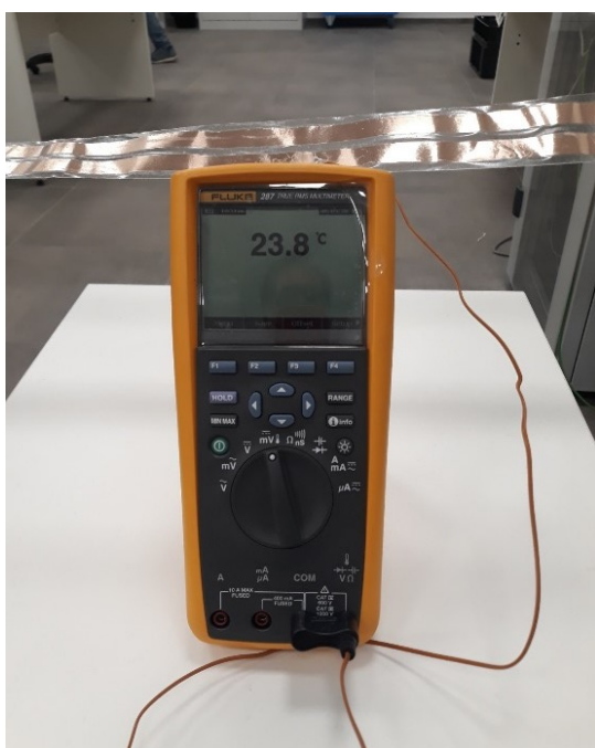
Figura 1: multimetro digitale a vero valore RMS Fluke 287 con sonda termica DMM integrata Fluke 80BK-A durante una prova di portata
