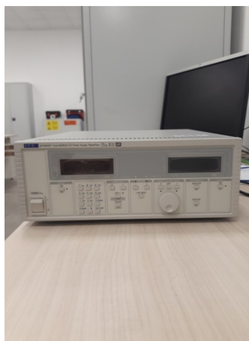
Figura 2: alimentatore programmabile c. c. da banco Aim-TTi QPX600DP, 80V/50A da 600 W con doppia uscita.
