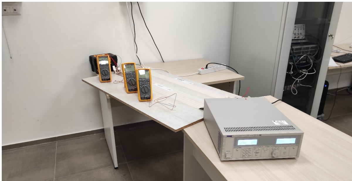
Figura 15: prove di portata effettuate sul nastro elettrico biadesivo NM3BT25 in posa su legno.
