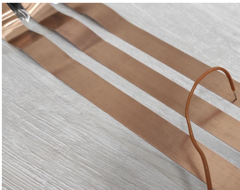
Figura 16: particolare del posizionamento della sonda per le misure di temperature sulla guaina isolante durante le prove di portata effettuate sul nastro elettrico biadesivo NM3BT25 in posa su legno.
